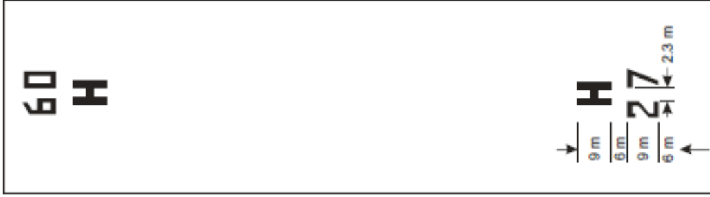
Şekil 3-3. Pist tipi FATO için FATO numaralandırma işaretlemesi ve heliport tanıma işaretlemesi
