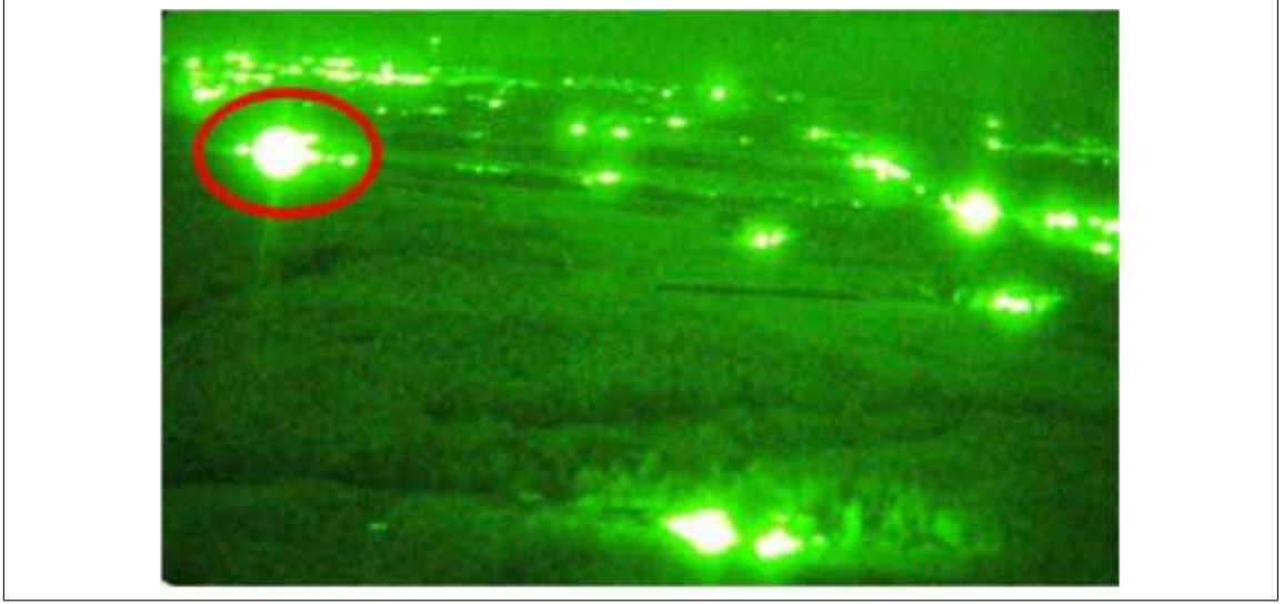
Şekil 12-17. NVG'lerden görülen şekliyle mania ılığı (daire içine alınmıştır) (kaynak: Kanada Ulusal Araştırma Konseyi)
