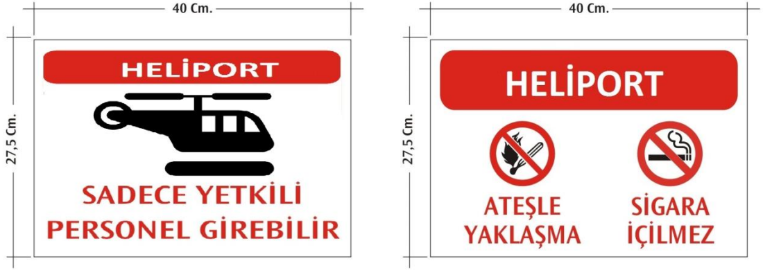
Şekil 4-1. Heliport Uyarıcı/Önleyici Levhalar (Örnek)
