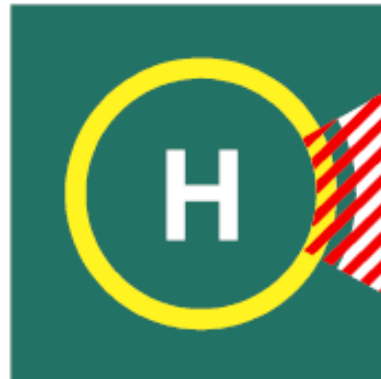
Şekil 5-7. Helidek yasaklı iniş sektörü işaretlemesi
