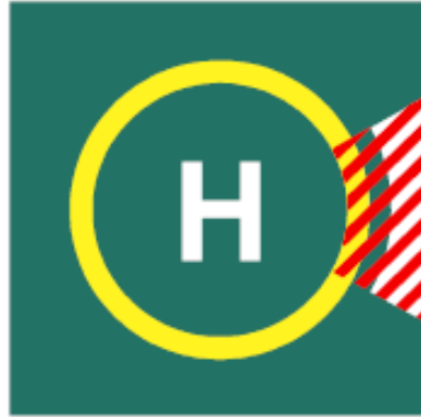
Şekil 3-6. Helidek yasaklı iniş sektörü işaretleme
