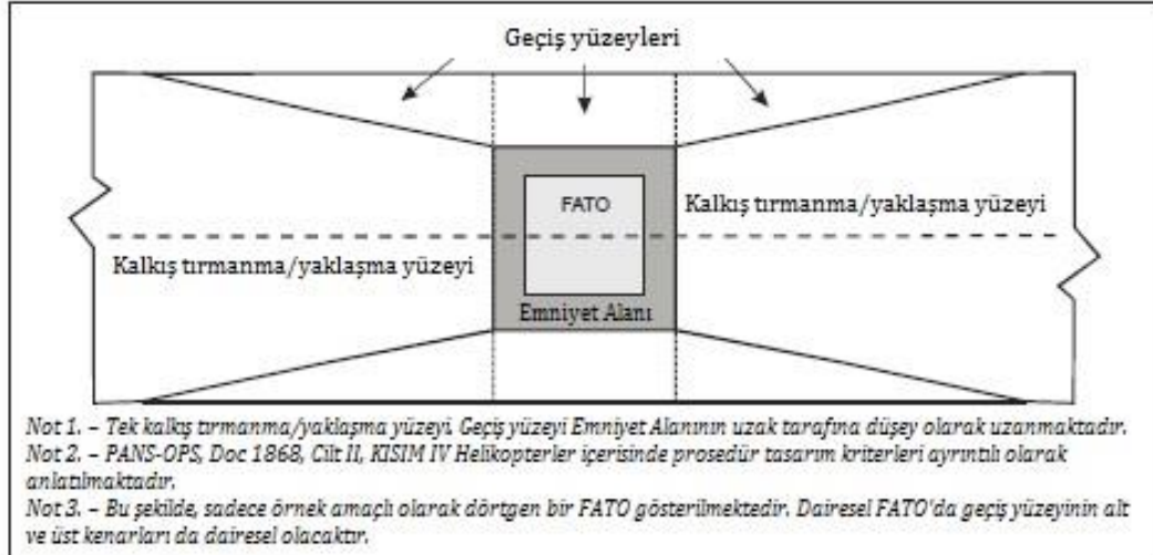
Şekil 4-3. VSS ile PinS yaklaşma prosedürü bulunan FATO için geçiş yüzeyi
